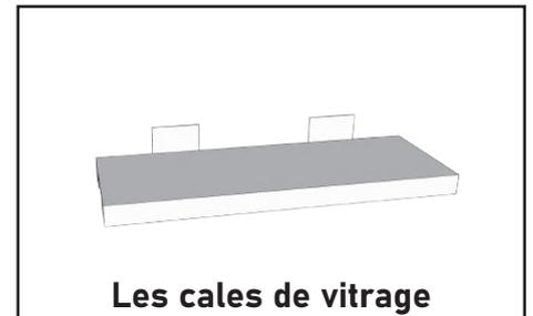
Les précales et les cales réhaussées sont préalablement positionnées dans la menuiserie.
