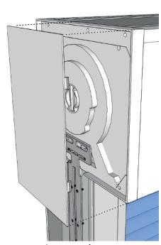
Une fois la fenêtre posée, clippez les plaques de finitions fournies sur les deux côtés du volet
